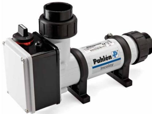
Električni grejači napravljeni su od termoplastike za dodatnu jačinu. Grejni elementi su napravljeni od čelika ili titanijuma za dodatnu sigurnost u bazenima gde postoji povećan rizik od korozije. Sadrže termostat za podešavanje temperature kao i prekidač za zaštitu od pregrevanja i prekidač za protok.
