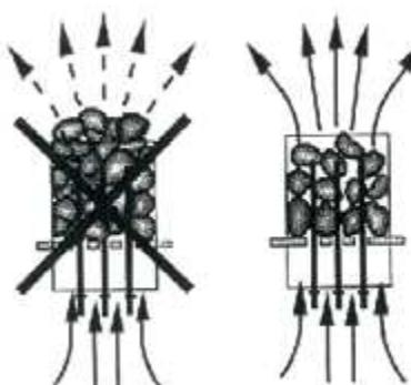
**Upozorenje! Oštećenje peći uzrokovano pregrevanjem usled korišćenja neadekvatnog i nestručno složenog kamena, nije pokriveno garancijom.**
